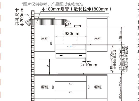
吸油烟机的出风口到排气孔的距离不宜太长，以小于1.5m为宜，且转弯数量不应多于2个。
